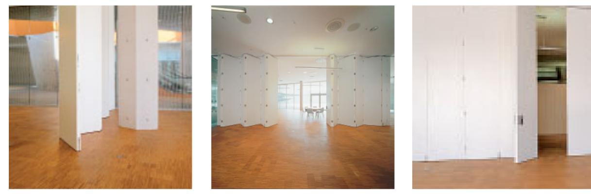
Die Faltwände ‚F5, F6, F7 und F8‘ unterscheiden sich in ihrer Flügelstärke von 5 bis 8 Zentimetern und den damit wachsenden Schalldämmwerten von 25 bis 38 Dezibel. An der Decke lassen sich die Flügel in einer Alu-Laufschiene mit 4-fach kugelgelagerten Rollenwagen manuell bewegen. Mittels Kantenriegeln werden die Flügel am Boden zu einer ebenen, feststehenden Wandfläche arretiert. Der Ausgleich von Bodenunebenheiten erfolgt durch Schleifdichtungen.
