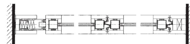
*Querschnitt und Hörschnitt GL 68, 2-Punkt-Aufhängung*
