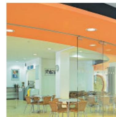
Die Elemente unserer Ganzglaswand GSW kommen ohne jeglichen Rahmen aus. Die Glasscheiben werden von Klemmschienen gehalten. Die sind in eloxiertem Aluminium, in Edelstahl und in jeder gewünschten RAL-Farbe lieferbar. Bodenschienen werden nicht benötigt. Die Arretierung der Elemente erfolgt über Riegel in Bodenrüfen.
